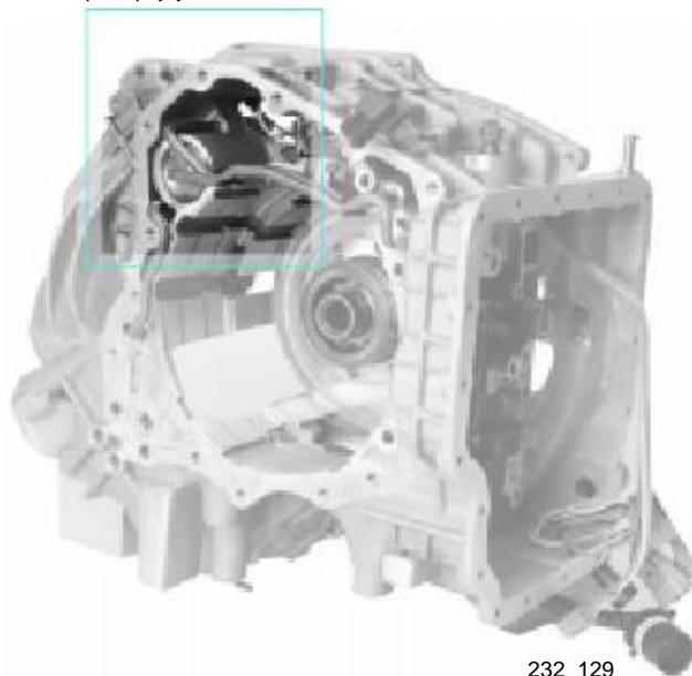
Tlaková nádoba v převodové skřini pro spojky K4
